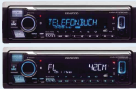
Die Beleuchtungsfarben von Display und Tasten können unabhängig voneinander beliebig variiert werden
